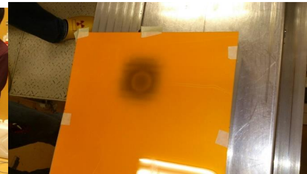
感光紙で測定した陽子 ビームのプロファイル
