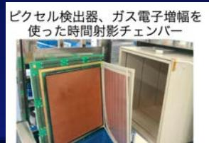
ピクセル検出器、ガス電子増幅を使った時間射影チャンバー
