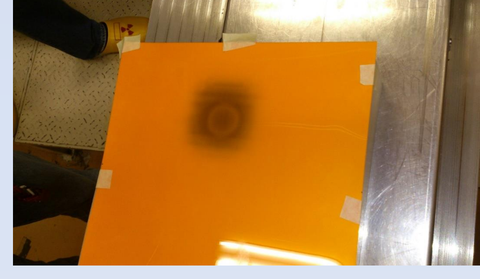
感光フィルムによるビーム強度とプロファイルの測定
